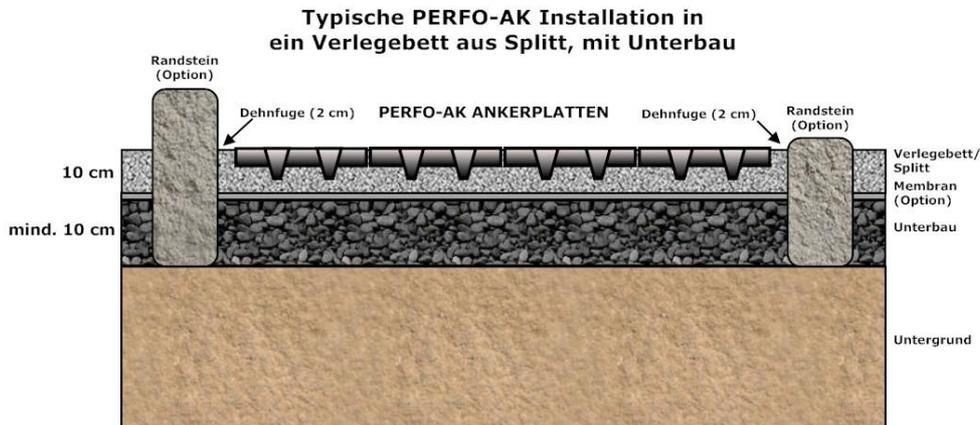
**PERFO-AK** –Platten können nach dem Kompaktieren auch mit einer Deckschicht aus Schotter oder Erde aufgefüllt werden und erneut mit Grassamen besät werden.
