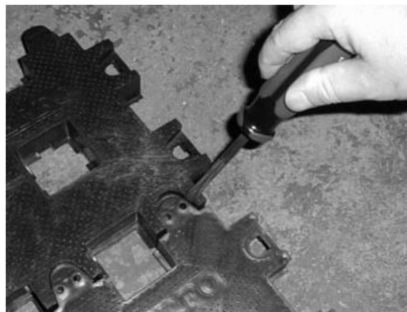
*Einzelne Elemente können abgetrennt werden, indem man die Verbindungsclips öffnet.*
