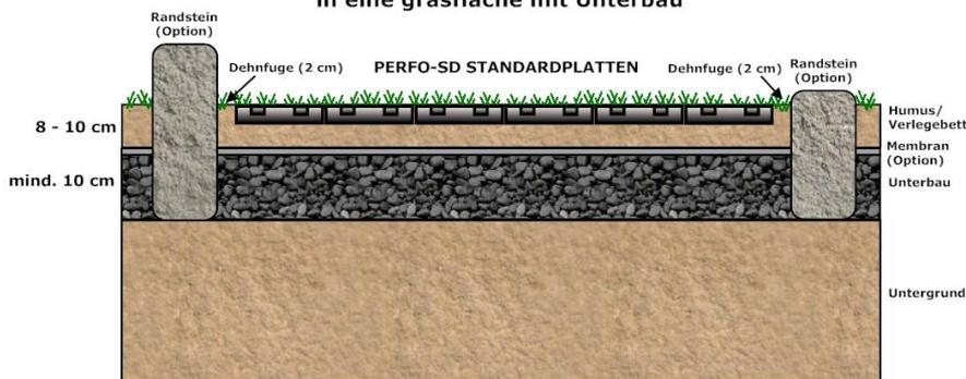
Typische PERFO-AK Installation in eine Grasfläche mit Unterbau
